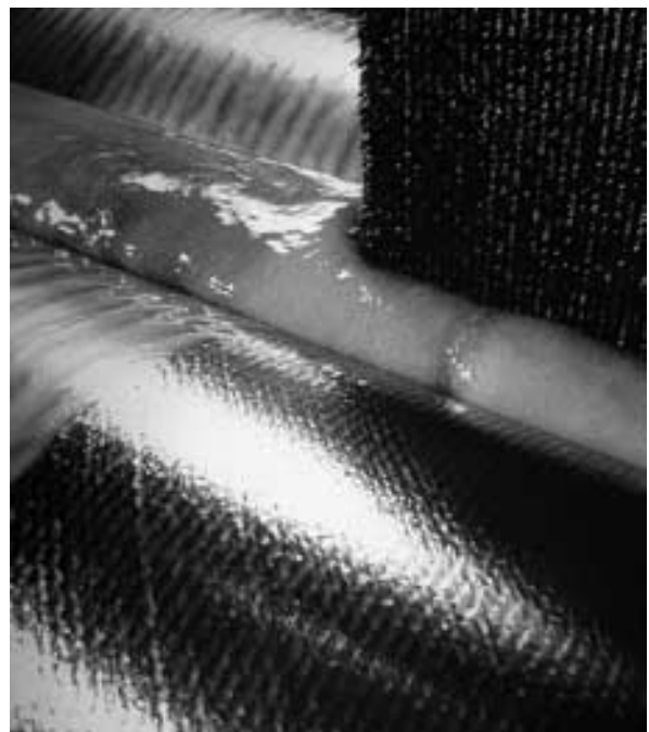
Fibre de carbone imprégnée par une résine de polymère (L'Art de l'ingénieur, expo CGP, Paris 1997)
